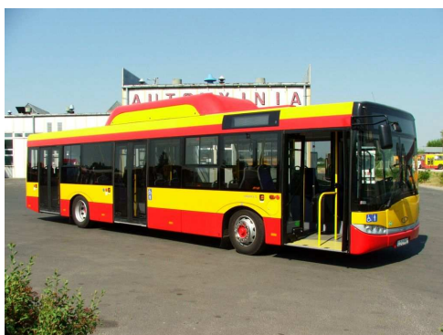
Autobus CNG o napędzie gazowym
