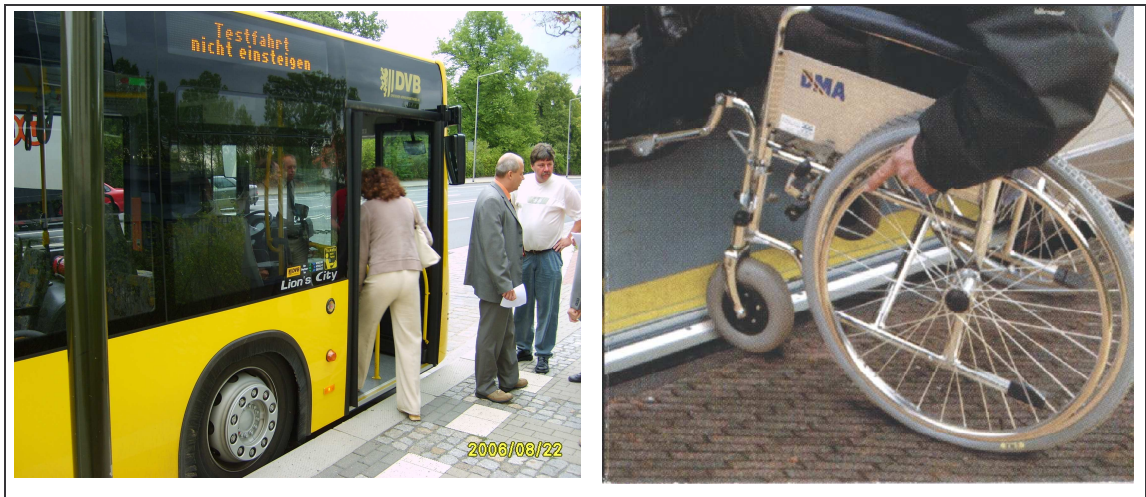
Rys. III.13. Przystanki z podwyższonymi nawierzchniami dostosowane do potrzeb osób niepełnosprawnych
