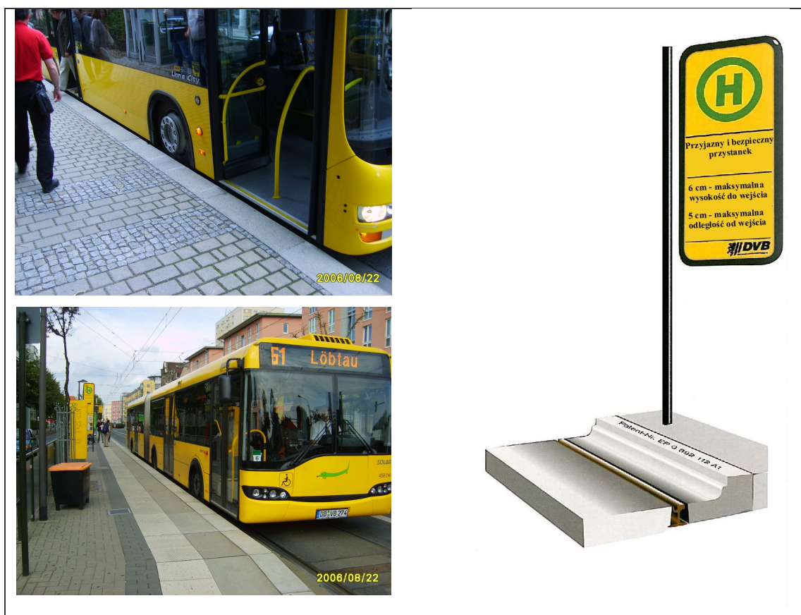
Rys. III.5. Przystanek dostosowany do wysokości podłogi w autobusie
