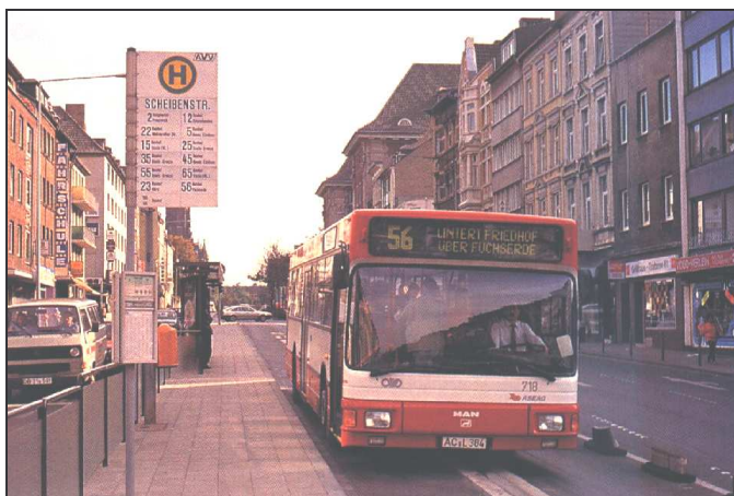
Rys. III.31. Przystanek na środku jezdni
